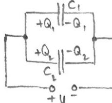
$$Q_{\text{összes}} = Q_1 + Q_2 = C_1 U + C_2 U = \underbrace{(C_1 + C_2)}_{C_{\text{eredő}}} U$$
