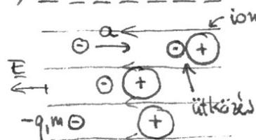
elektron mozgása két ion ütközés között:
