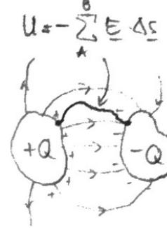
Megjegyzések: •  $C$  csak a geometriától függ!
