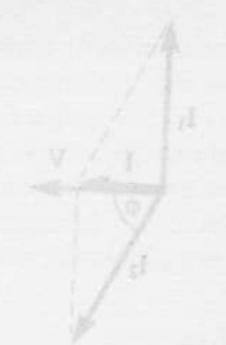
(d) Az áramerősség-vektor (áram) a rezonancia állapotban a feszültség-vektorral szembe fordított irányú.
