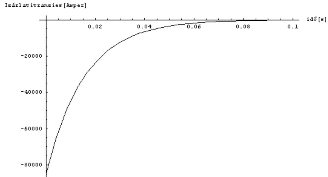
**5. lépés : A zárlati áram időfüggvényének meghatározása**
