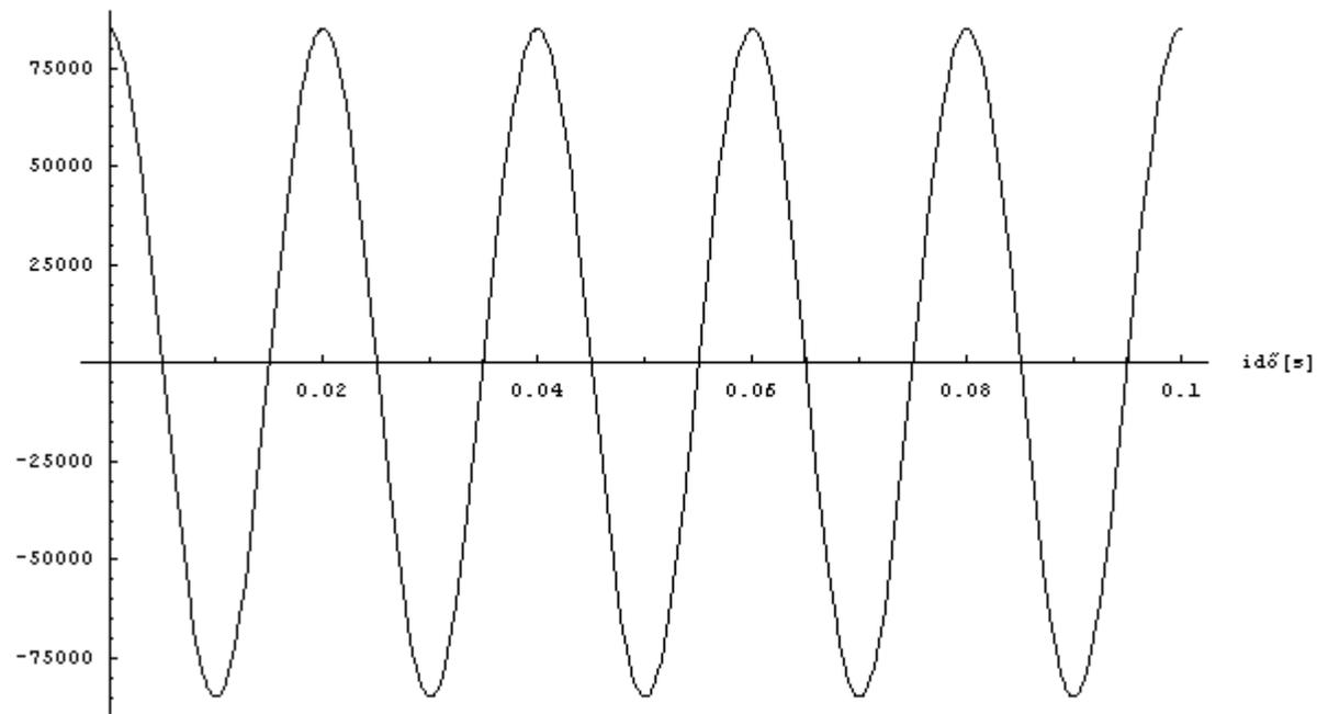
**3. lépés : A zárlati feszültség meghatározása a bekapcsolási szög figyelembevételével**
