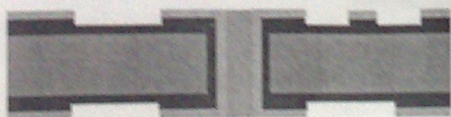
6. ábra. A feleslegessé vált fotoreziszt leoldása
