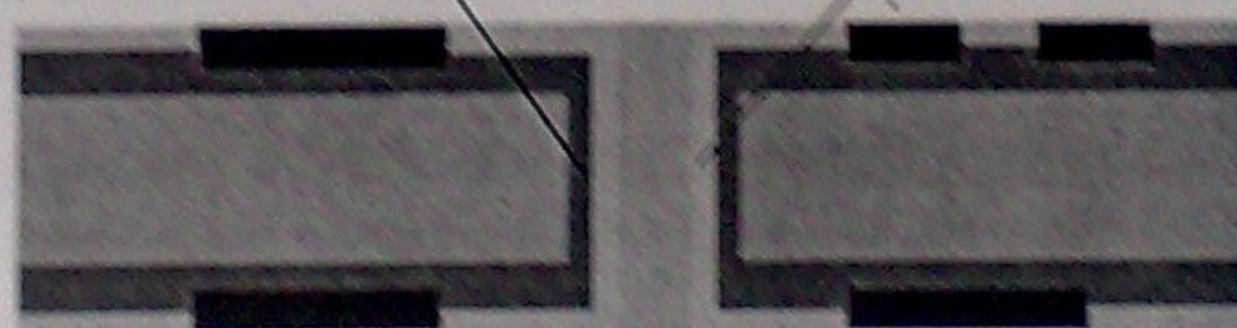
5. ábra. Hordozó a rajzolatgalvanizálás után
