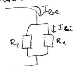
$$I_{ee} \cdot R_{\text{eq}} = I_{ki} \cdot R_1$$
