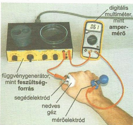
10. ábra. A bőrimpedancia mérési elrendezése.
