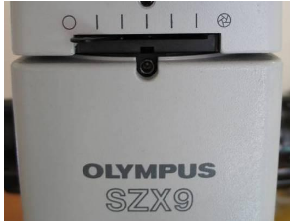
3. ábra: SZX9 rekeszátmérőjét beállító kapcsoló
