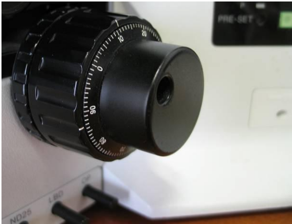
4. ábra: BX51 fókuszáló egysége: a belső nagyobb résszel durván, a külsővel finoman változtatható a mintatartó magassága
