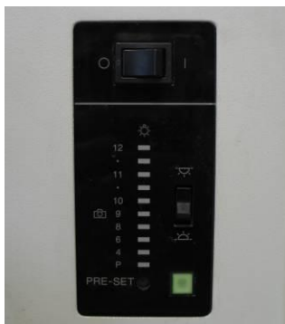
6. ábra: BX51 főkapcsolója, világítási irány kapcsolója és automata fényerősséget beállító gombja
