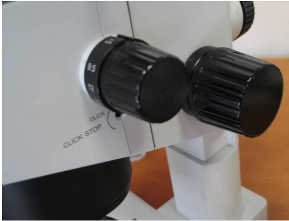
2. ábra: SZX9 nagyítást beállító és fókuszáló kezelőszervei
