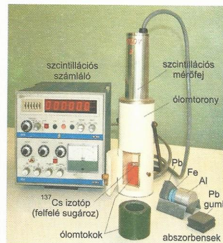
9. ábra. A \gamma -abszorpciómérés összeállítása J_0 mérésehez.
