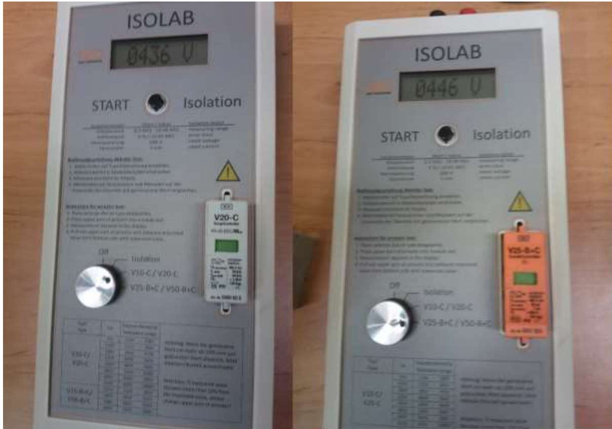
8. ábra: A két varisztor jellemzőinek kimérése
